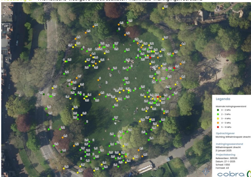
Afbeelding 2. Thematische weergave meetresultaten maximale indringingsweerstand
